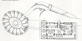
Grundriss Gartengeschoss: Im Neubau vorne Zimmer, hinten Garage, im Altbau Restaurant- und Seminarräume, dazwischen Verbindungsgang
