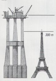
will, hat andere Dimensionen. Die Bohrplattform für Erdgas ist bis zur Oberkante der Betonpfähle 370 Meter hoch und steht rund 300 Meter im Wasser. Gesamthöhe inklusive Aufbauten und Kranen: 470 Meter. Unser nationaler Ingenieurrekord, die Mauer der Grande Dixence, reicht diesem Ungetüm knapp bis zur Brust.
