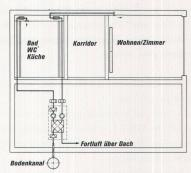
Prinzipschema der Lüftungsanlage
