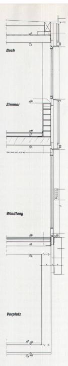
Fassadenschnitt der Strassenfassade. Werkplan der Metron 1:10 Dach: Kaltdecke über Betondecke, Isolation mit 24 cm Isofloc-Schüttung, Begrünung Wand: 20 cm Kalksandstein, Vertikal- und Horizontalplattung, dazwischen total 16 cm Mineralwolle, aussen 3-Schichtholzplatten
