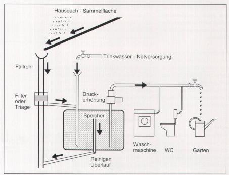
Schema einer Regenwasseranlage
