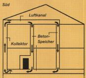
Schema der Luftführung bei Ofenbetriebbe-
