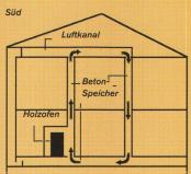
Über ein Rohrsystem strömt Warmluft ins Gebäudeinnere, in Böden und Wände
