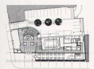
Grundriss Erdgeschoss. Die Scheidewand teilt das Geschoss in Bankbetrieb einerseits und Restaurant anderseits.
