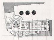
Grundriss Dachgeschoss. Der Schwung der Fassade setzt sich bis zur tragenden Scheidewand fort.
