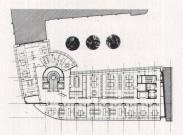
Grundriss Normalgeschoss. Zwei Erschliessungskerne, Stützen und die Pfeilerreihe am Korridor sind die konstruktiven Elemente.
