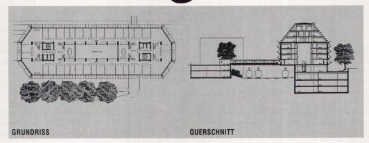
Der Grundriss eines Normalgeschosses und der Schnitt im Projekt von Sik. Der Schnitt zeigt innenliegende Halle, Auskragung, Fussgängerübergang und Parkgarage unter dem Waldufer.
