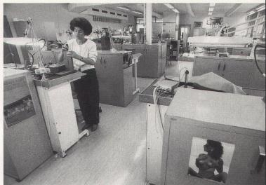
Uhren sind die einzigen Massenprodukte der Schweiz – 78 Millionen Stück werden pro Jahr produziert. Davon werden 95 Prozent exportiert. Trotz «Swatch» blieb Uhrenarbeit Industriearbeit: Montage, Konfektion Qualitätskontrolle und Batteriewechsel (von links) sind Handarbeiten.
