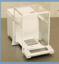
Hochpräzisionswaage Mettler AT261
