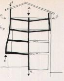
Deformationsschema des Hauses. A: Mittelwand mit 40 cm Setzung; B: Fassade durch Eigenlast verformt und gespalten; C: Zugwirkung auf die Fassade durch die Geschossdecken.
