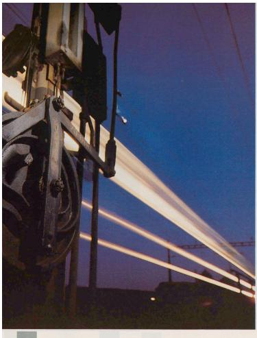
Wären zwei orange Lichter sichtbar, so würde der Lokführer wissen, dass das Hauptsignal geschlossen ist, er müsste «Halt erwarten». Der Abstand zwischen Vor- und Hauptsignal ist so bemessen, dass jeder Zug – auch bei voller Streckengeschwindigkeit – bis zum Stillstand abbremsen kann.
