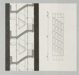
Querschnitt durch den Schaft und Abwicklung der inneren Fassade (links). Die Betonkonstruktion berührt den Fels nur dort, wo sie sich gegen ihn stemmt, um sich abzustützen.
