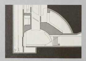
Schnitt durch die untere Halle, den oberen Abschluss und Grundriss des Schaftes (oben). Die Sicherheitsvorschriften verlangten zwei Notausgänge. Das Ergebnis dieser Forderung ist der innenliegende Turm. Dem sagt man aus der Not eine Tugend machen.
