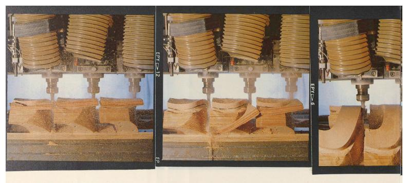
Nach geringfügigem Umrüsten werden die Stuhllehnen für das Modell 3300 an derselben Oberfräse wie die Sitzflächen ausgeschnitten. Die Kanten und Rundungen müssen von Hand geschliffen werden.
