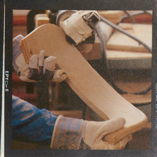
Beim Modell 3700 werden abgebogene Schichtholzteile auslaufend zugefräst und in den entsprechenden Vertiefungen am Sitz verklebt.
