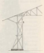
Der Blick unters Dach und die Skizze des Hallenbinders zeigen, wie die freistehende Konstruktion der Halle räumlich stabilisiert worden ist.
