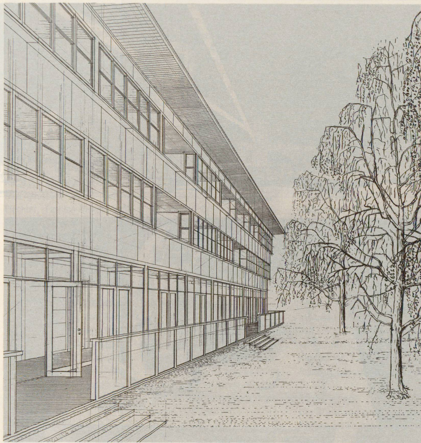
Einpassung in Ort und Landschaft (links), Konstruktion aus dem traditionellen Fundus der Gegend: ein einfacher Baukörper mit einer Fassadenverkleidung aus Holz (oben), da der reine Holzbau aus feuerpolizeilichen Gründen heute kaum mehr möglich ist.
