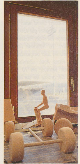
Entwurf im Dreidimensionalen: Schaumstoffmodelle für Terratracs.
