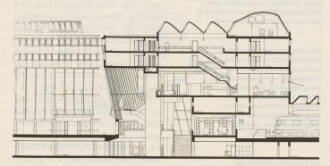
Modellaufnahmen, Grundriss 4. Obergeschoss. Schnitt durch den Konfhau und Fotomontage des Projektes für den Bahnhof Luzern. In den Obergeschossen befindet sich ein Hotel das an der geschlossenen Fassade ablesbar ist. Darunter die Glaswand
