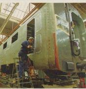
Der TEE-Zug wurde bis auf sein Rohrge-rippe ausgeweidet. Neu eingebaut wurde nun der EC-Zug. Doch die «Schweizer Qualität» ist keineswegs das Beschauliche. Die Arbeiten mussten unter äusserstem Zeitdruck ausgeführt werden.
