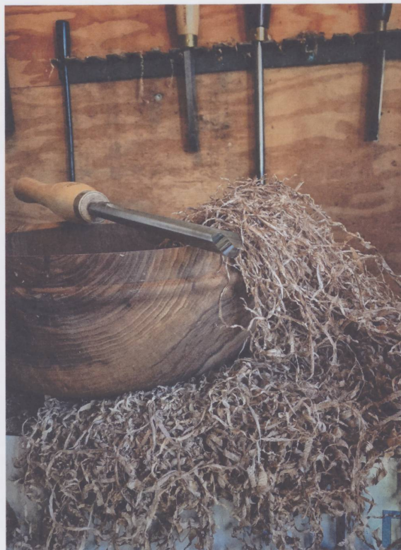
Figure 8 : saladier en noyer, une gouge fraîchement affûtée afin d'obtenir des copeaux fins et une finition parfaite. (Photo Carrelet, 2021)
