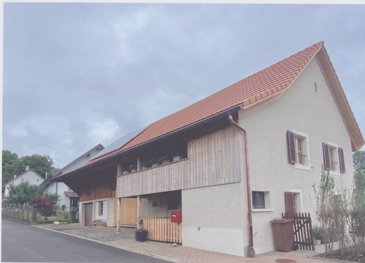
Figure 2 : À l'est, la façade longe la route principale. État après transformations en 2020-2021. (Photo Bureau Arches 2000 SA, 2021) Pose d'une nouvelle couverture en tuiles et de panneaux solaires sur le toit. Les murs ont été enduits de crépi au-dessus du soubassement, tandis que les lames de bois existantes ont été sablées. L'ancienne porte du garage tout à gauche a été conservée mais l'espace est devenu un lieu de rangement.
