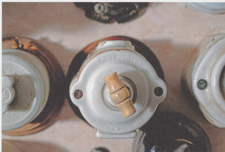
Figure 2 La première trouvaille, « le premier objet qui m'avait flashé, c'était un interrupteur en céramique (L 6 cm / P 6,5 cm) démonté dans la ferme Berthold rue des Planchettes. C'était en 1986 ou 1987. Le bouton est en bakélite, un des premiers dérivés du pétrole. On utilisait aussi cette matière au cours des années 1930 dans les appareils de transmission. Du point de vue du coût, du poids et peut-être même de la solidité, c'est plus pratique que la céramique. C'est le premier objet avant la déconstruction que j'ai démonté pour le garder. Il appartenait au quotidien. Il était même utilisé plusieurs fois par jour. J'avais pris conscience que ce genre de dispositif disparaîtrait au profit d'autres le plus souvent en matière plastique. Du coup, j'ai commencé une collection, que je continue. » (Photo JLM, 2017)
