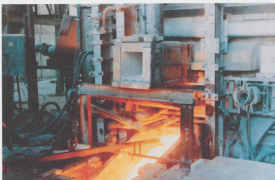
Figure 1 À la fin d'une « campagne », le four doit être vidé et les briques réfractaires changées. Les habitants de Moutier allaient régulièrement assister à ce spectacle. (Photo non datée mise à disposition par le Musée du Tour automatique et d'Histoire de Moutier)
