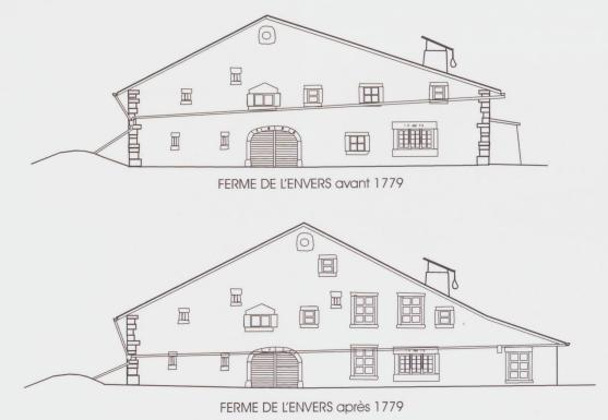
Figure 15 Évolution de la ferme. Après 1779, le chéneau cache les deux dates sur le porche, celle de 1652 et celle gravées sur la fenêtre à meneaux (1673). Il a été supprimé. (Dessins d'H. Schneider, 1987).
