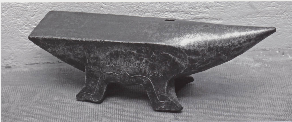
Figure 17 Enclume « à corps » d'armurier. Hauteur 19 cm, longueur 60 cm, largeur 19 cm, poids 57 kg ; œillet porte-outil. Inscription: CLAUDINON, de part et d'autre en dessous (?1441 et 57 K. Filet en accolade séparant la date au centre 1905 (date de fabrication.) (Photo JLM.)
