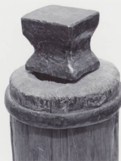
Figure 19 Enclume de tonnelier. Hauteur 12 cm, largeur 11 cm, épaisseur 10 cm, poids total avec socle 26 kg, sans socle 10 kg. (Photo JLM.)
