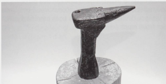
Figure 16 Enclume à tige de ferblantier (?). Hauteur 22,5 cm, longueur 19 cm, largeur 6,5 cm ; poids total avec socle : 17,5 kg, 4 trous ronds à percer. L'instrument a la forme d'une tête d'oiseau. (Photo JLM.)
