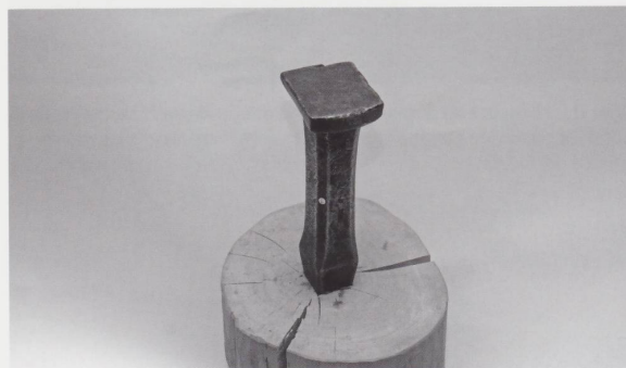
Figure 15 Enclume à tige de dinandier ou de forgeron. Hauteur 25 cm, longueur 10 cm, largeur 8 cm, poids non mesuré, sur billot. Epoque: vers 1900. (Photo JLM)
