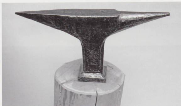
Figure 14 Enclume à tige de dinandier ou de ferblantier. Hauteur 24 cm, longueur 52 cm, largeur 7,5 cm, poids non mesuré ; bigorne à deux bouts, 1 bout arrondi et un bout carré. Epoque: 1625. (Photo JLM)
