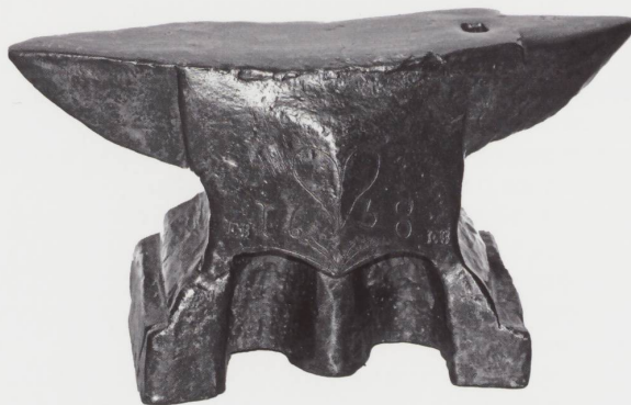
Figure 1 Enclume de forgeron dite « à corps », la première de la collection, le premier coup de cœur. Hauteur 29 cm. Longueur 54 cm, largeur 11 cm, poids 83 kg : 2 bigornes, 1 çaillet porte-outil. Très belle forme arrondie du refouloir. Inscriptions : 1638 (année de fabrication), un cœur gravé au centre, un bouquet de 3 tiges ; initiales JCB (?) à gauche et à droite sur l'estomac. (Photo JLM.)
