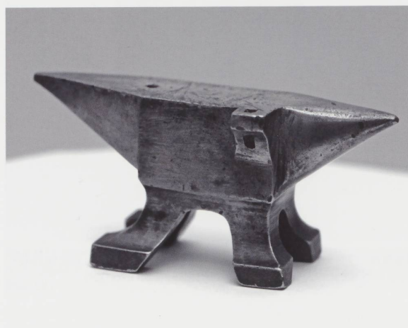
Figure 23 Enclume d'horloger (?). Hauteur 4,5 cm, longueur 10 cm, largeur 2 / 3 cm (avec nez comprenant un œillet porte-outil), poids env. 0,2 kg ; en laiton ; 1 bigorne à pointe carrée, 1 arrondie, 1 œillet à percer. (Photo JLM.)
