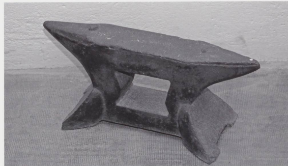
Figure 6 Enclume de forgeron dite « à corps ». Hauteur 28 cm, longueur 64 cm, largeur 10 cm, poids 70 kg ; 1 œillet porte-outil et 1 œillet à percer. Remarquable par son espace vide à l'intérieur. Epoque XIX e siècle. (Photo JLM.)
