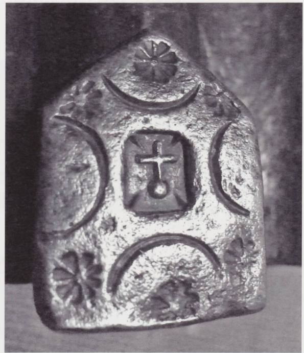
Figure 25 (a, b) La régionale , Enclume « à corps » de forgeron. Hauteur 30 cm, longueur 41 cm, largeur 8 cm, poids 66 kg ; 1 cœillet porte-outil. Acquis aux Franches-Montagnes: un instrument fabriqué sur place. Sceau sur la face du refouloir. (Photo JLM.)
