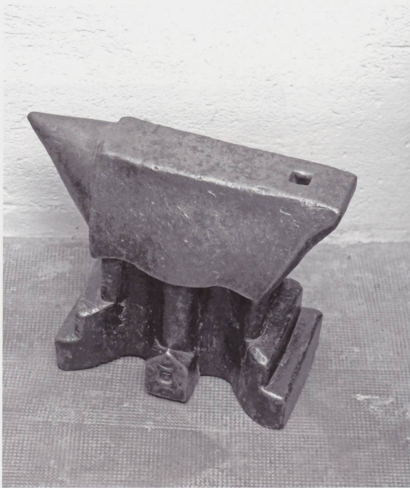
Figure 25 (a, b) La régionale , Enclume « à corps » de forgeron. Hauteur 30 cm, longueur 41 cm, largeur 8 cm, poids 66 kg ; 1 cœillet porte-outil. Acquis aux Franches-Montagnes: un instrument fabriqué sur place. Sceau sur la face du refouloir. (Photo JLM.)
