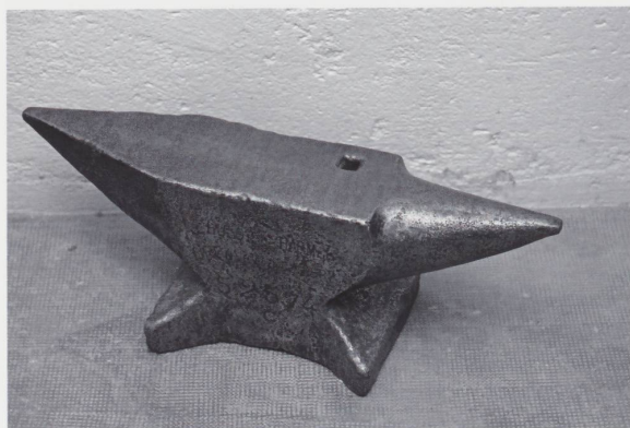
Figure 9 Enclume de forgeron dite « à corps ». Hauteur 21 cm, longueur 62 cm, largeur 12 cm, poids 62 kg ; œillet porte-outil. Inscription : HULOT HARMEL et d'autres en dessous peu lisibles, 52574, C, 63 (kg) (Photo JLM.)
