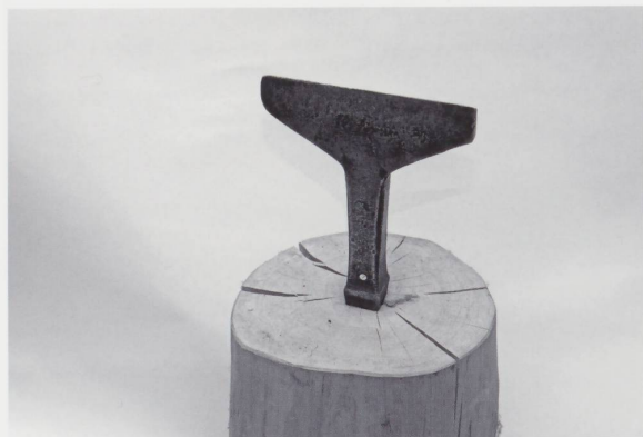
Figure 18 Enclume « à tige » de dinandier (ou de ferblantier) pour plier le métal, voire le couper. Hauteur 27 cm, longueur 22 cm, largeur 0,2 cm ; poids non mesuré. Époque : vers 1900 ; inscription effacée. (Photo JLM.)
