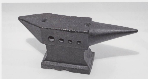
Figure 7 Enclume de forgeron dite « à corps ». Hauteur 21 cm, longueur 47 cm, largeur 10 cm, poids 30 kg ; 1 œillet porte-outil et 1 œillet à percer ; 4 trous de côté. (Photo JLM.)
