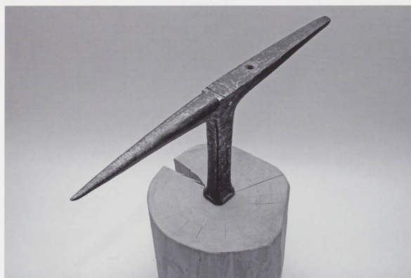
Figure 11 Les enclumes à tige. Enclume de ferblantier ou dinandier. Hauteur 27 cm, longueur 62 cm, largeur 4 cm, poids 23 kg avec socle; bigorne 1 bout pointu et 1 bout rond; dessus : 3 rainures; époque: XIX e siècle. (Photo JLM.)
