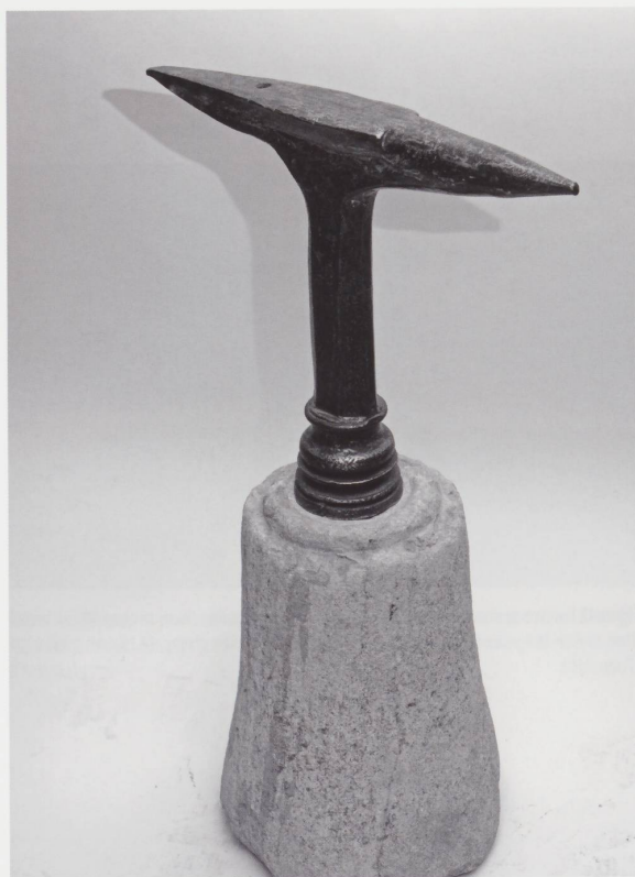
Figure 13 Enclume à tige de ferblantier, la seule sur socle de pierre. Hauteur 35 cm, longueur 41,5 cm, largeur 6 cm, poids total avec socle 45 kg. (Photo JLM)
