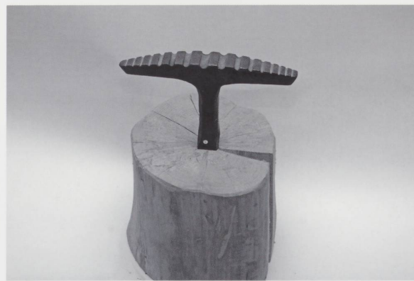
Figure 12 Enclume de dinandier ou de ferblantier dite « à tige ». Hauteur 18 cm, longueur 29 cm, largeur 4 cm, environ 15 kg; sur billot; légèrement courbée pour former des gorges; 16 rainures; vers 1900. (Photo JLM.)
