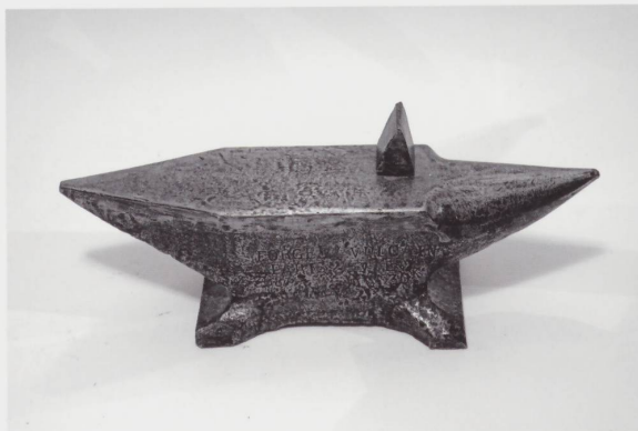
Figure 3 Enclume de forgeron dite « à corps ». Hauteur 15 cm, longueur 50 cm, largeur 10 cm, poids 30 kg ; avec son outil dans l'œillet ; Inscriptions : FORGES VULCAIN PARIS 7 E (L?) 5368 30 K 1983 (?) (Photo JLM.)
