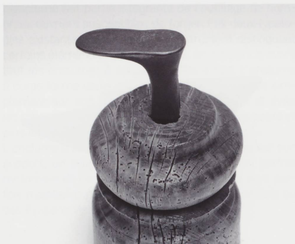
Figure 21 Pied de cordonnier. Hauteur 47 cm (outil 12 cm), longueur 12 cm, largeur 4,5 cm, poids 0,3 kg ; support sur bois tourné. (Photo JLM.)
