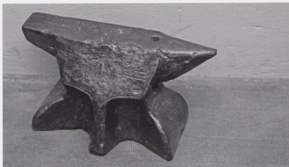
Figure 5 Enclume de forgeron dite « à corps ». Hauteur 28 cm, longueur 53 cm, largeur 10 cm, poids 97 kg ; 1 œillet porte-outil. Inscriptions effacées. Refouloir. (Photo JLM.)
