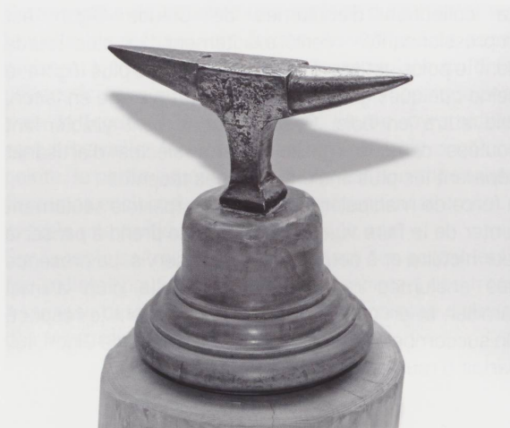
Figure 22 Enclume d'horloger (?). Hauteur 22 cm (outil 10 cm), longueur 23 cm, largeur env. 4 cm, poids 2 kg ; 1 support sur bois tourné en forme de cloche ; 1 bigorne ronde, 1 carrée, un petit trou à percer. (Photo JLM.)
