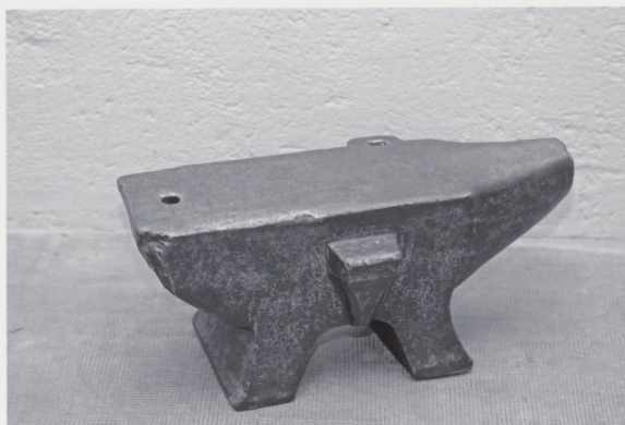
Figure 10 Enclume d'armurier dite « à corps ». Hauteur 24 cm, longueur 53 cm, largeur 15 cm, poids 92 kg ; socle plat ; œillet porte-outil dans nez) et œillet à percer, 2 nez. Inscriptions : Malespine à St-Etienne 1845 1011 (Photo JLM.)
