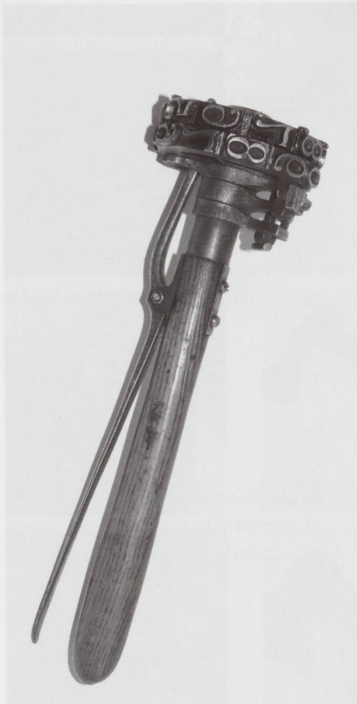
Figure 4 : Le marteau de cubage permettait de marquer un numéro d'identification sur chaque grume ou chaque lot de bois de chauffe. Le levier sert à avancer d'une unité. Ce marquage se fait maintenant grâce à une plaquette en plastique portant un numéro. Photo J.-L. Merçay.
