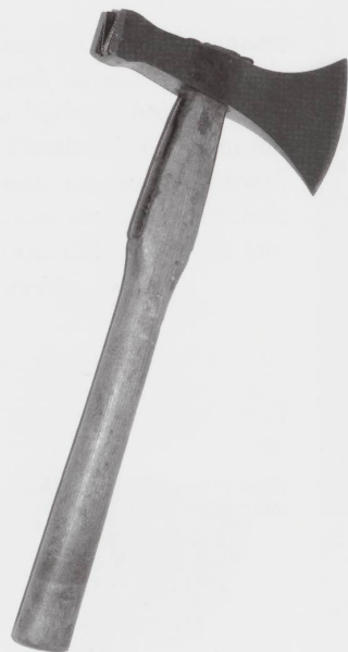
Figure 1: Hache de martelage et de cubage. La partie marteau porte l'initiale de la commune ou du propriétaire: ici, M, comme Miécourt. Photo J.-L. Merçay.
