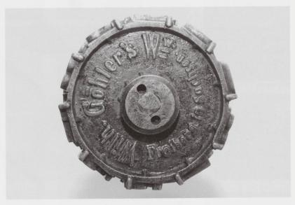
Figure 4 : Le marteau de cubage permettait de marquer un numéro d'identification sur chaque grume ou chaque lot de bois de chauffe. Le levier sert à avancer d'une unité. Ce marquage se fait maintenant grâce à une plaquette en plastique portant un numéro. Photo J.-L. Merçay.
