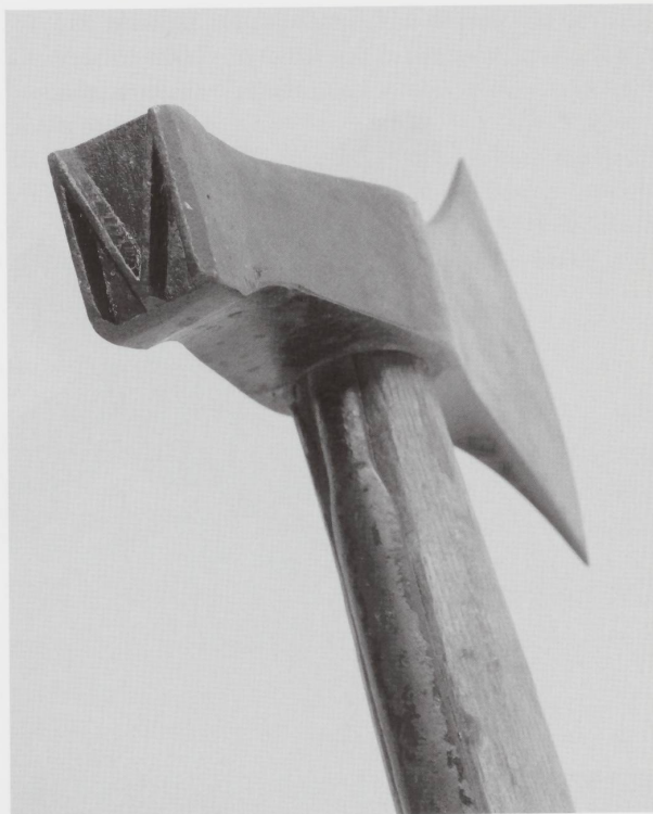
Figure 1: Hache de martelage et de cubage. La partie marteau porte l'initiale de la commune ou du propriétaire: ici, M, comme Miécourt. Photo J.-L. Merçay.
