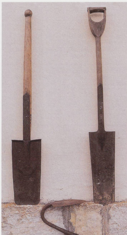
Deux bêches et une curette de fond utilisées au cours des travaux de drainages à Develier dans les années 1941 à 1943. Musée Chappuis-Fähndrich, Develier. Photos Raphaël Eggenschwiler, Bourrignon.
