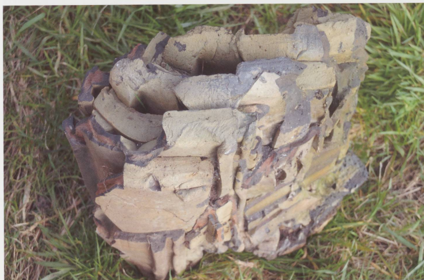
Figure 12 : tuiles soudées à la suite d'une surchauffe : elles iront au rebut. Photo Jean-Louis Merçay.
