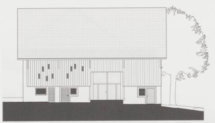
Plan de la façade sud-est et sa réalisation. La disposition des ouvertures dans la grange n'a rien d'aléatoire mais est dictée par la nécessité de maintenir intacte la structure de la charpente et le désir de privilégier certaines vues.
