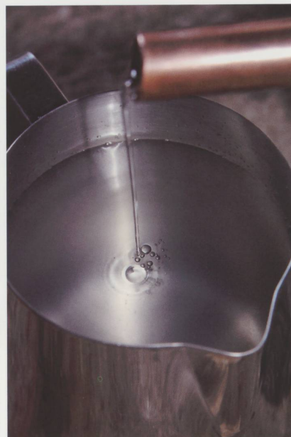
A la sortie de l'alambic, raffinage de l'eau-de-vie dit « à la goulotte ».
