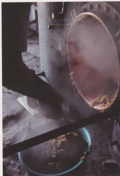
Fin de la première cuisson : on évacue les fruits après la première distillation du moût.
