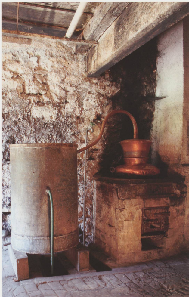
Ce très ancien alambic à feu direct (sans bain-marie) se trouve à la métairie de Nidau, sur le territoire de la commune de Sonceboz-Sombeval. Disposant d'une grande capacité pour l'époque, il est le plus vieux loin à la ronde encore en action. Une particularité : son refroidisseur est alimenté par une source naturelle.
