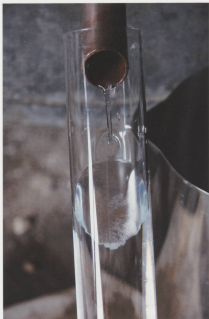
A la sortie de l'alambic, une pellicule d'huile essentielle se forme à la surface de l'eau-de-vie.
