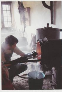
Nettoyage de la cuve avant la deuxième chauffe (aubrant).
