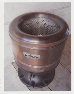
Essoreuse en cuivre restaurée par René Chaboudez. La turbine ne nécessitait que 7 litres d'eau environ par essorage. Collection privée.
