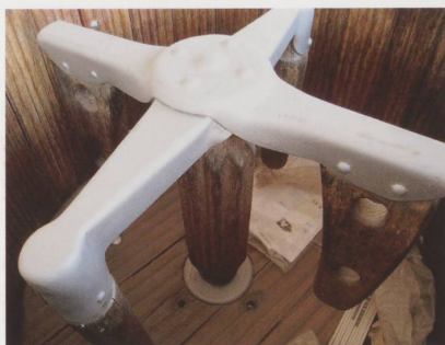
Lessiveuse avec mouvement de va-et-vient. Les ailettes sont en bois (rare). En général, c'est en métal. Elle marchait à l'aide d'un moteur agricole. Collection Prudat, Courgenay.
