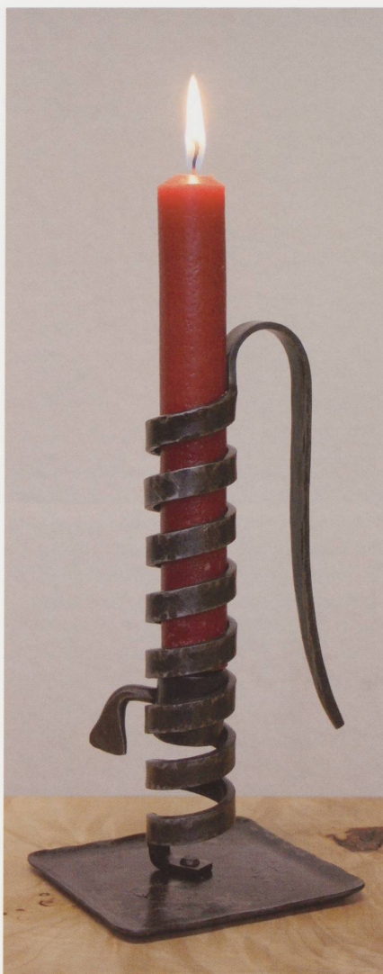
Le bougeoir rat-de-cave que Serge Turberg forgea devant nous (voir la fin de l'article). Sa poignée (la queue de rat) donne une prise en main facile et sûre. Sa forme permet de le suspendre à un clou ou de l'accrocher aux rebords des fûts de chêne. Grâce à son système astucieux de spirale, la chandelle est toujours positionnée judicieusement à mesure qu'elle se consume.
