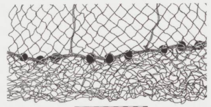
Dessous, détail de la bordure du même épervier, avec les liens qui soutiennent la gouttière.
