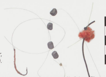
Bas de ligne pour pêcher au ver, avec un repère de profondeur (Epauvillers).
