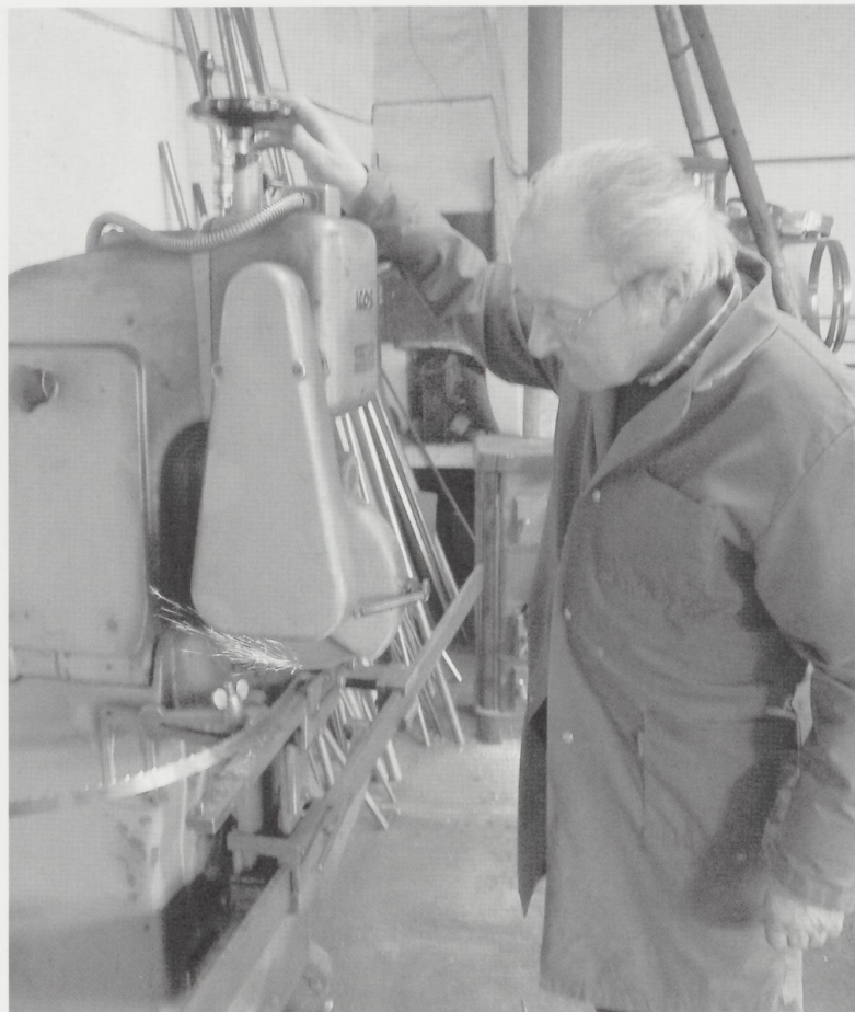
A gauche : le réglage de l'affûteuse est délicat. Dernière étape, l'affûtage. La lame doit effectuer trois passages. Les dents s'aiguisent dans le mouvement.
