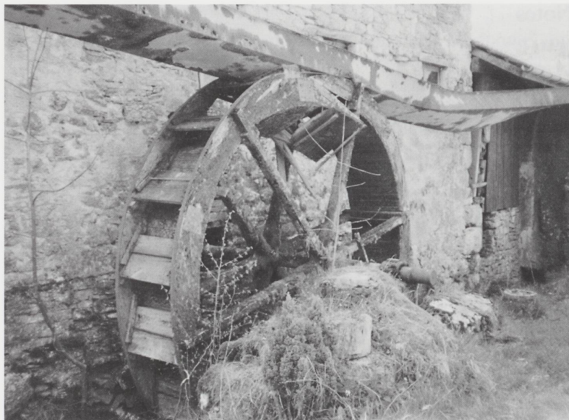
Moulin de Soubey. L'ancien canal d'amenée d'eau en tôle et l'ancienne roue à auges avant leur remplacement en 1998. Photo Pierre Froidevaux, 1998
