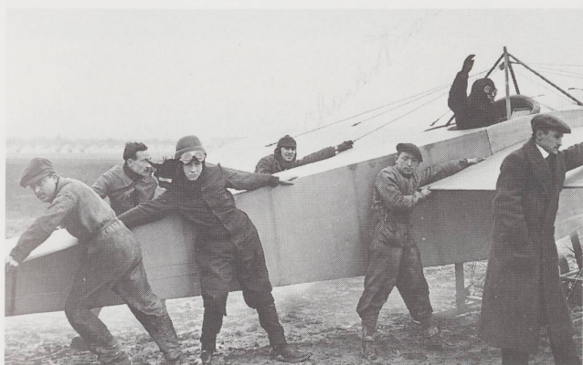
Le Neuvevillois Charles Favre à bord de son «Hanriot» en 1912. Pour gagner de la distance et de la puissance au décollage, l'avion est retenu jusqu'au moment où le pilote peut s'assurer que le moteur tourne à plein régime.
