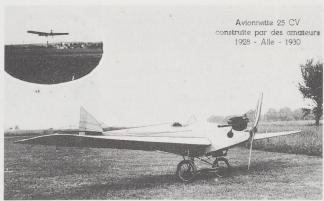
L'«Avionnette» construite en 1928 par le club d'Alle. Ce petit monoplace n'est encore équipé que d'un moteur de 25 CV. Il est équilibré au moyen de pommes de terre judicieusement placées dans les ailes!
