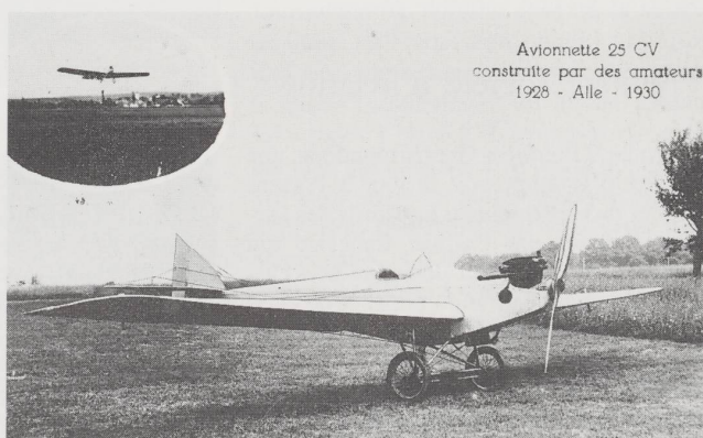
L'«Avionnette» construite en 1928 par le club d'Alle. Ce petit monoplace n'est encore équipé que d'un moteur de 25 CV. Il est équilibré au moyen de pommes de terre judicieusement placées dans les ailes!
