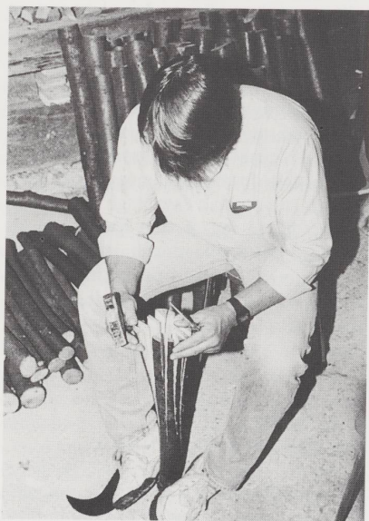
Réalisation d'une fave. Première étape: les troncs de 60 cm environ sont fendus à plusieurs reprises à l'aide d'un marteau et d'un couteau sur les \frac{3}{4} de leur hauteur. Fontenais, 1996. (Photo G. Gigon)
