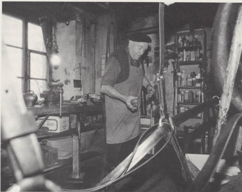
Préparation du fil: le sellier l'enduit de poix et de cire d'abeille afin qu'il ne pourrisse pas à la pluie. Photo: Dominique Dumas.
