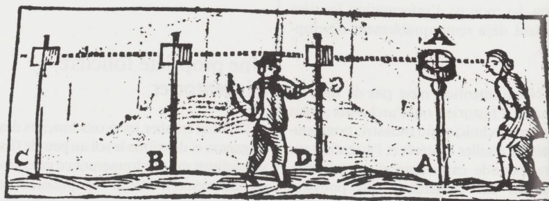
Fig. 3: Arpenteurs lors d'un levé orthogonal (1757).
