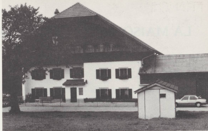
Un exemple d'une rénovation à la bernoise, à la Montagne du Droit : avant-toit à berceau orné d'une grande courbe lambrissée façon emmenthaloise. Malgré la vigoureuse rénovation, le décrochement en façade paraît indiquer un bâtiment plus ancien déjà transformé auparavant. Vue du sud en 1988.
