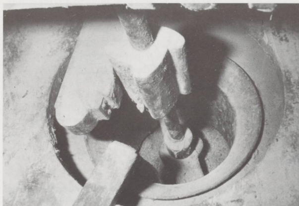
Le centre de la meule supérieure (courante) avec le frappeur à quatre dents (babillard) qui provoque la vibration de l'auget.
