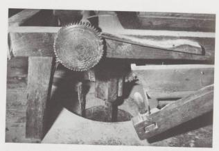
Petit treuil commandé par un système à encliquetage réglant l'inclinaison de l'auget. (Photos Randoald Dessarzin.)
