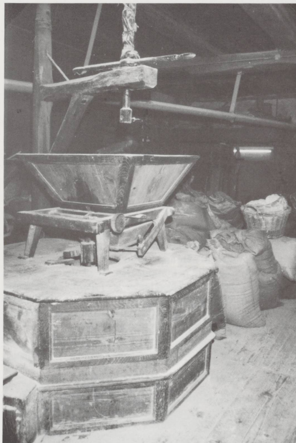
Une paire de meules se trouve dans ce coffrage (archure). En dessus, on voit le système de distribution du grain qui tombera entre les meules par le trou (œillard) pratiqué au centre de la meule supérieure (courante).
