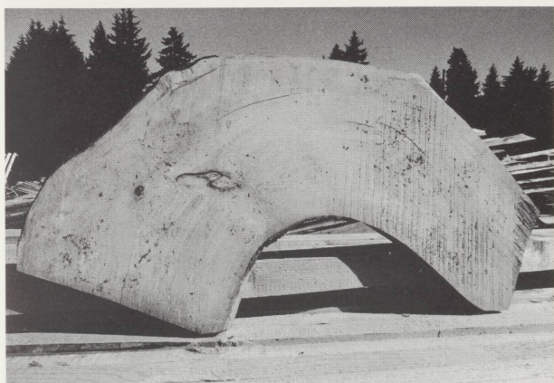
Les « courbes » qui constituent l'ossature de la barque seront découpés dans des planches de bois dur de 5 cm d'épaisseur ou tout autre tronc ayant déjà la forme voulue naturellement.
