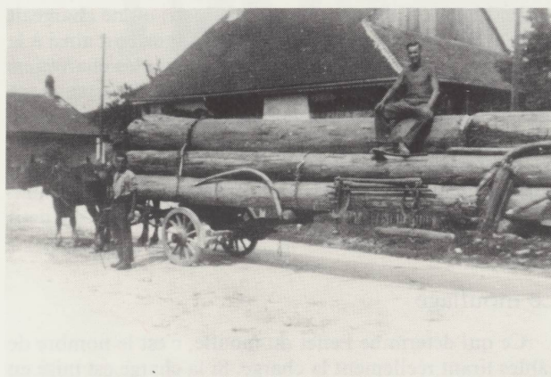
Sur cette photo, on distingue les tendeurs dits «souëtats», les chaînes, le paquet d'outils, etc. (Photo appartenant à M. Chalverat, Roches)
