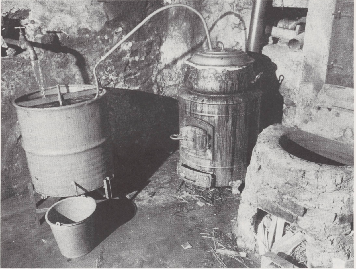
Installation avec cucurbite et tonneau de refroidissement modernes.
