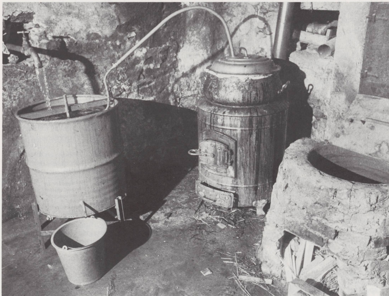
Installation avec cucurbite et tonneau de refroidissement modernes.
