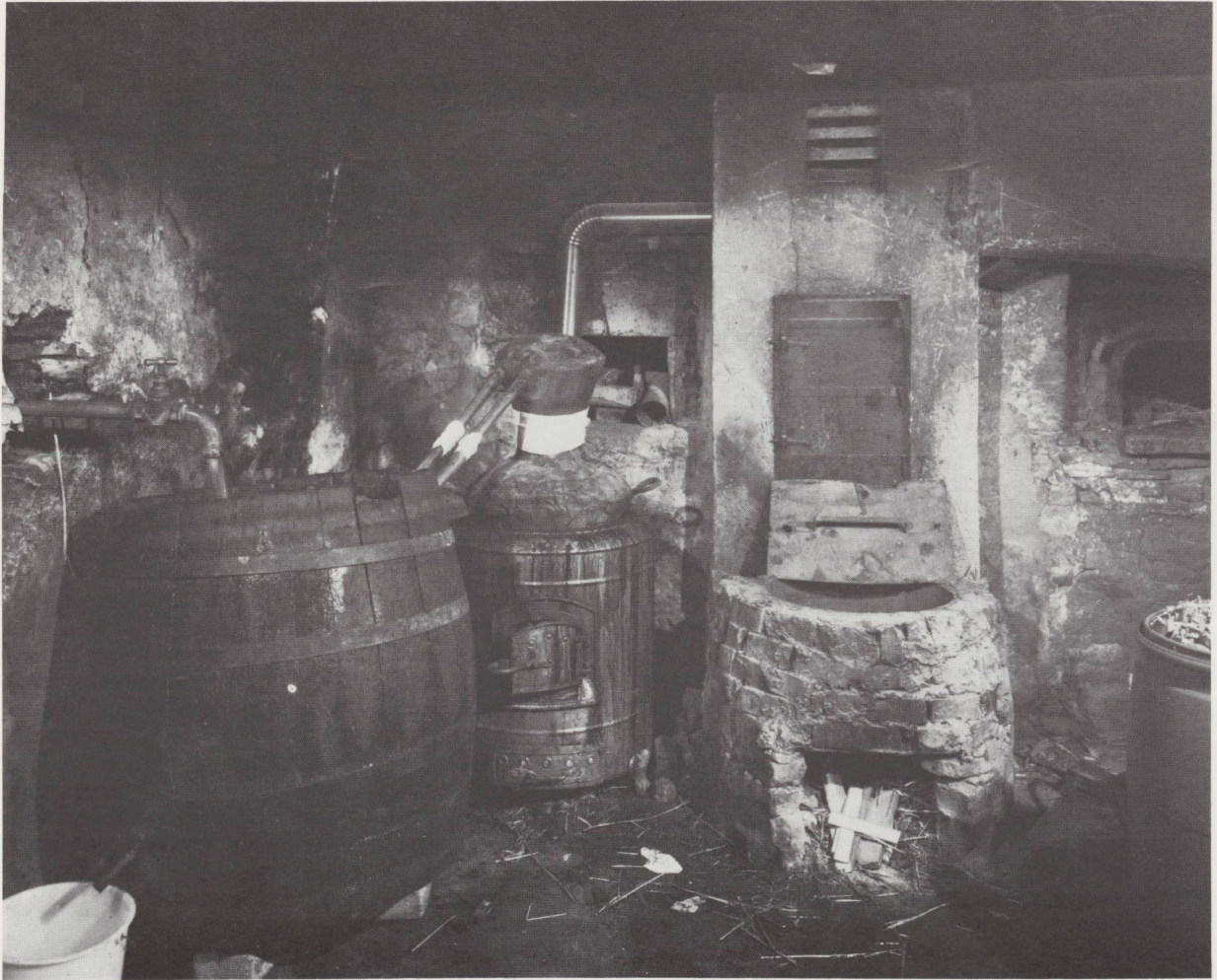
A Oisonfontaine : de droite à gauche, le tonneau rempli de fruits sous la bouche du four à pain, puis l'ancien fourneau maçonné sur lequel on plaçait autrefois la cucurbite, enfin l'alambic à feu nu avec chaudière moderne et cucurbite ancienne d'où partent les serpentins qui traversent le tonneau de refroidissement. La goutte tombe dans le seau en plastique.
