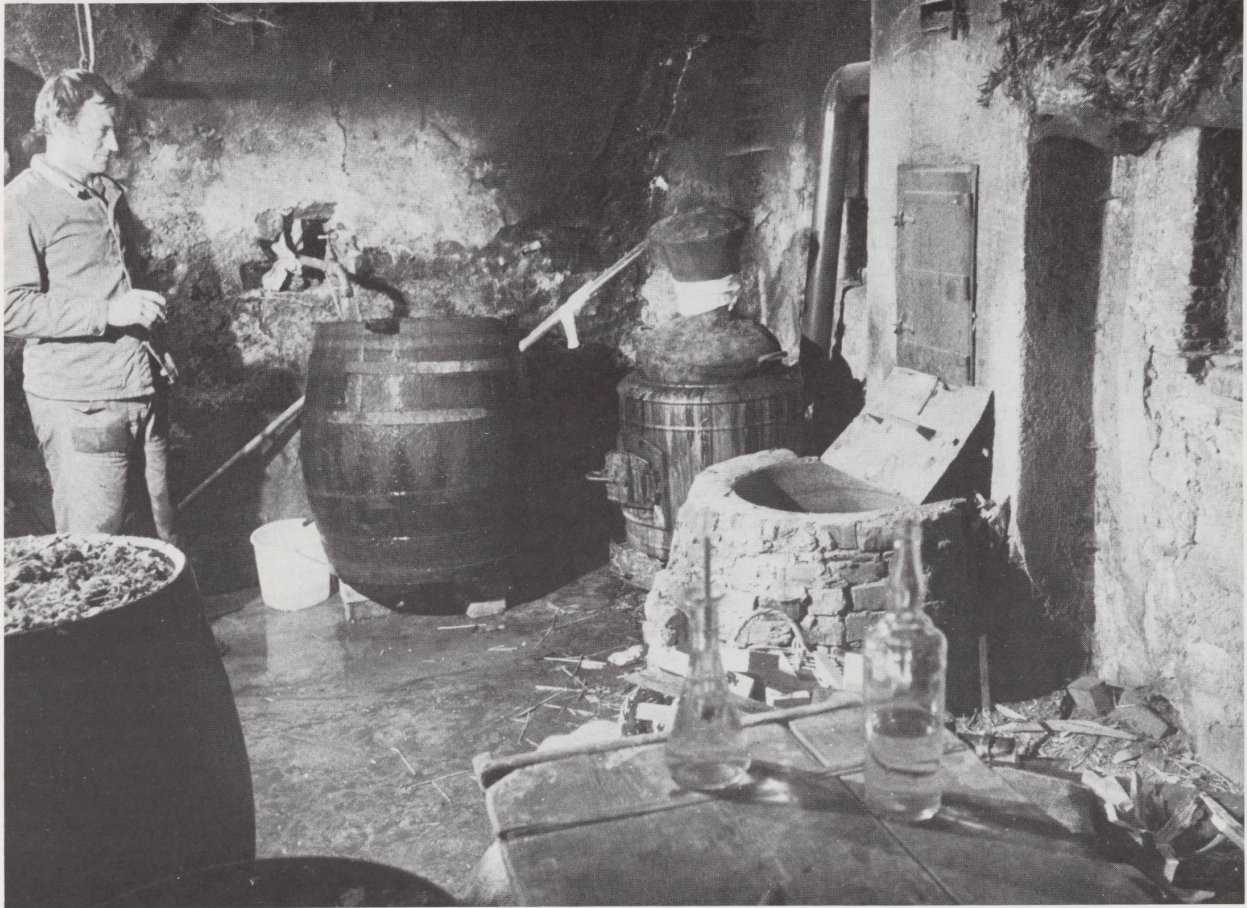
Local de distillation à Oisonfontaine. Dans l'angle, alambic à feu nu avec chaudière moderne et cucurbitte ancienne d'où sortent les serpentins qui traversent le tonneau de refroidissement à eau ; la goutte tombe dans un seau en plastique ! Au premier plan : tonneau rempli de fruits fermentés. Derrière la table : ancien fourneau d'alambic maçonné sur lequel on plaçait la cucurbitte. Tout à droite : bouche du four à pain.
