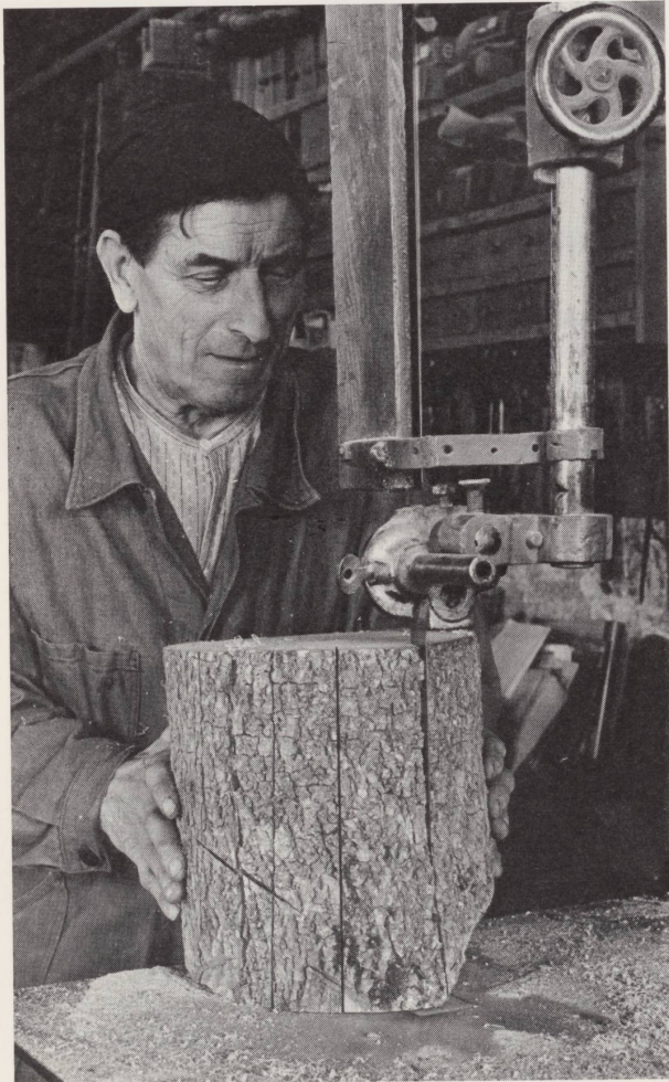
Façonnage d'un cylindre dans une pièce d'érable.
