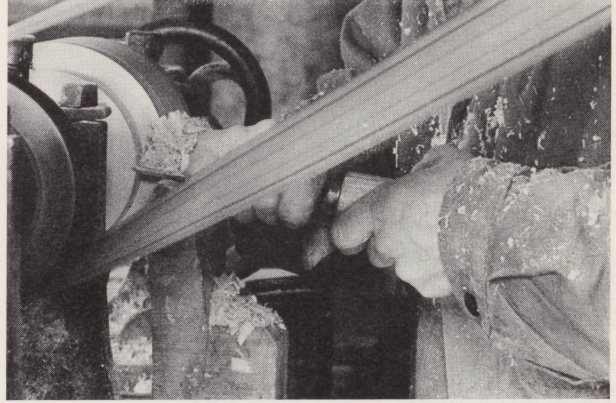
Tournage pour obtenir la forme d'un moyeu.
