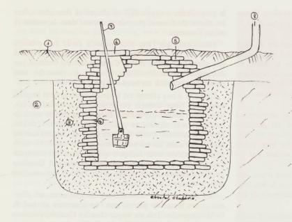
Coupe d'une citerne : 1. Gazon ; 2. roche schisteuse ; 3. Marne d'étanchéité ; 4. mur de la citerne ; 5. Voûte en tas de charge ; 6. Margelle et ouverture de puisage ; 7. Poujou ; 8. Descente du toit.
