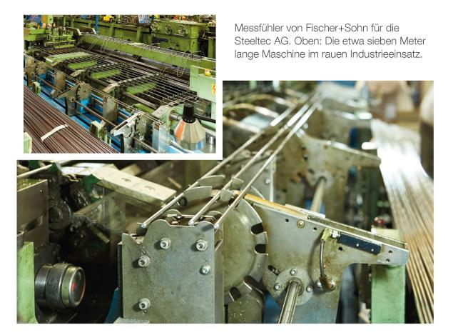
und Konstruieren unterschiedlichster Vorrichtungen und Maschinen. So zum Beispiel benötigte die Firma Steeltec AG in Emmenbrücke eine Vorrichtung, welche die von ihr produzierten Stahlstangen auf ihre Geradheit prüft. Nur so kann sichergestellt werden, dass die weiteren Verarbeitungsschritte wie Drehen, Gewindeschneiden reibungslos laufen. Fischer+Sohn entwickelte dafür einen Messfühler, der sich im Einsatz bestens bewährt.
