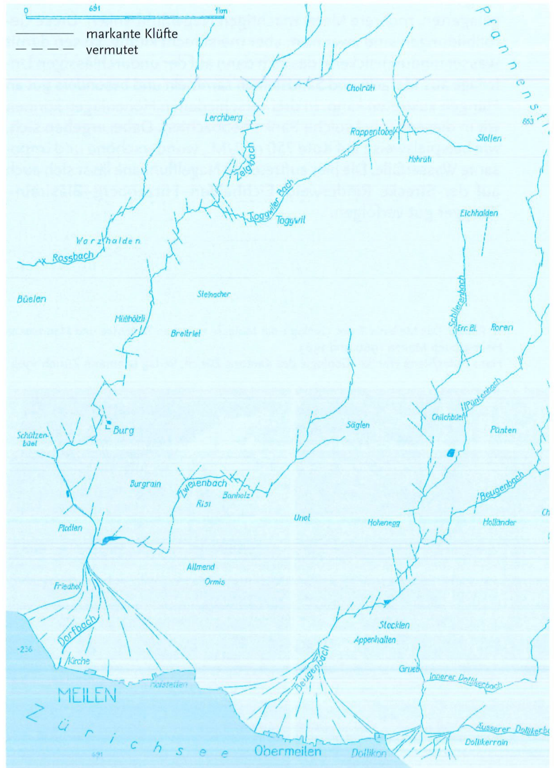
Abb. 1: Bedeutendere Klüfte mit Verstellung im Dorfbach- und im Beugenbachtobel, gezeichnet auf der Grundlage des Übersichtsplanes 2004, 1: 5000.
