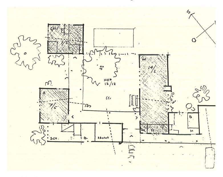
Projektskizze für eine Siedlung aus drei mit gedecktem Gang verbundenen Einzelgebäuden. (Die unterschiedliche Ausrichtung von Planund Windrosen-Beschriftung ist original.)
