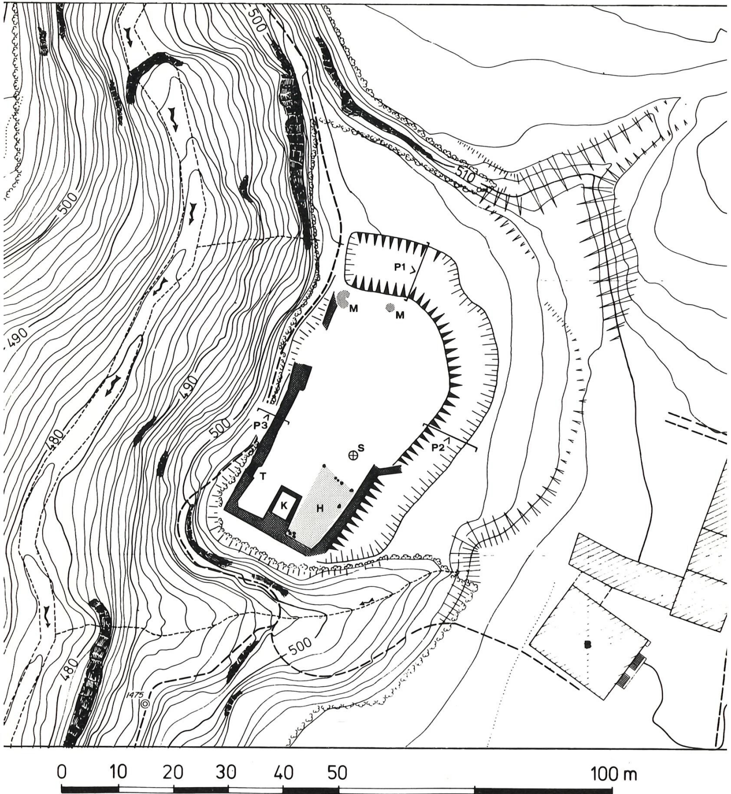
Topographischer Plan der Burgstelle Friedberg. Fläche 3,2 ha. Äquidistanz der Höhenkurven = 1 m. Aufnahme Bau- und Vermessungsamt Meilen, 28.8.1979. Zeichnung P. Albertin. S = Sodbrunnen, H = Vermuteter Grundriss eines Holzhauses, K = Keller, T = Tor zum Tobel, M = Mörtelspuren auf dem Fels, die auf die Fortsetzung der Umfassungsmauer hindeuten, P1, P2 Lage der beiden Profile, vgl. Abb.19/18.
