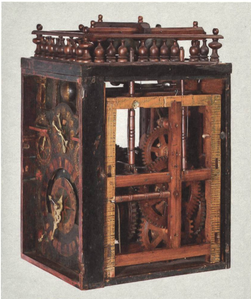
Blick von der Seite ins Räderwerk. Typisch für eine Berner Holzräderuhr sind die sechsspeichigen Zahnräder.
