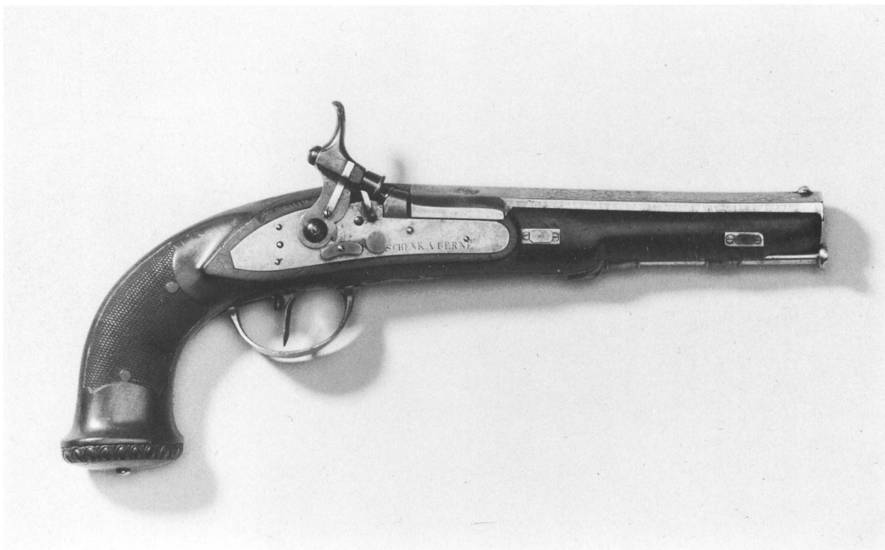
Perkussionspistole, Versuchswaffe mit Knallperlenschloss, um 1820 von Christian Schenk. Inv. 45 127 (Legat René Dollfus v. Volckersberg, Kiesen)
